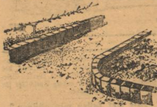
Abbildung 4. Vertrießung aus hochgehenden Mauersteinen.
