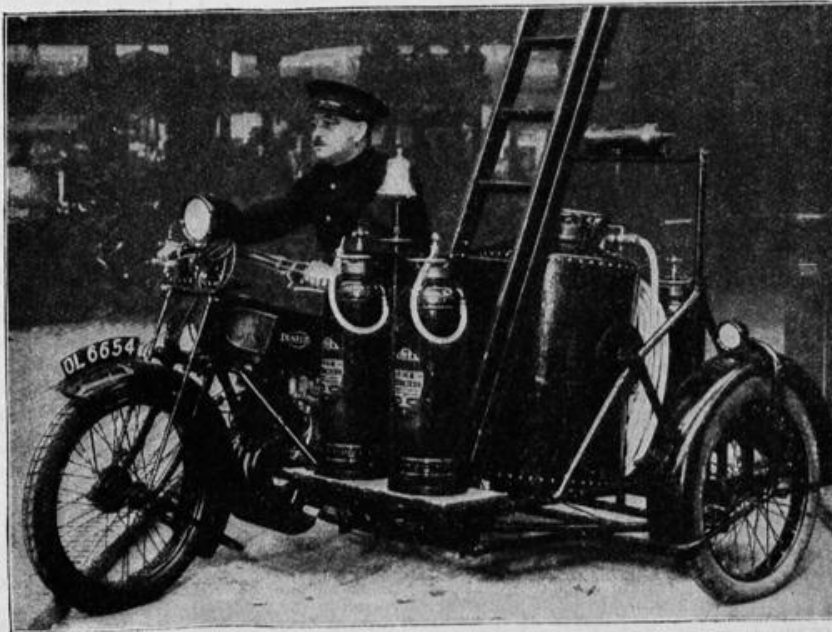
Das Ein-Mann-Feuerwehr-Motorrad. Der Feuerlöscher ist auf einem Motorrad angebracht und soll besonders bei kleineren Bränden die erste Hilfe leisten
