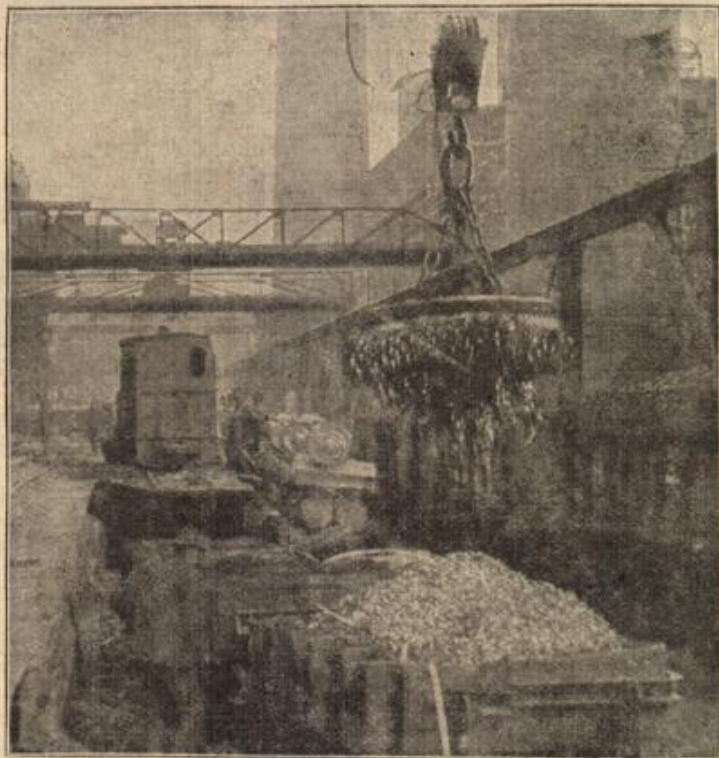
Elektrischer Magnetkran beim Verladen von Eisenspänen. (Mit Text.) (R. u. L. Kriegsministerium.)
