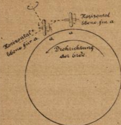
Zum Auffah: „Wegweiser des See- manns“: Schematische Darstellung des Einflusses der Erddrehung auf den Kreisellkompaß.
